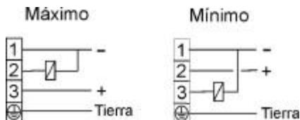
Cuando se conecta para detección de máximo, la carga estará "activada " cuando el detector no esté en contacto con el fluido. De la misma forma, cuando se conecta para detección de mínimo, la carga estará "activada " cuando el detector esté en contacto con el fluido.
