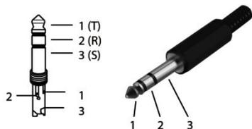
Configuración no balanceada, conector jack estéreo:
