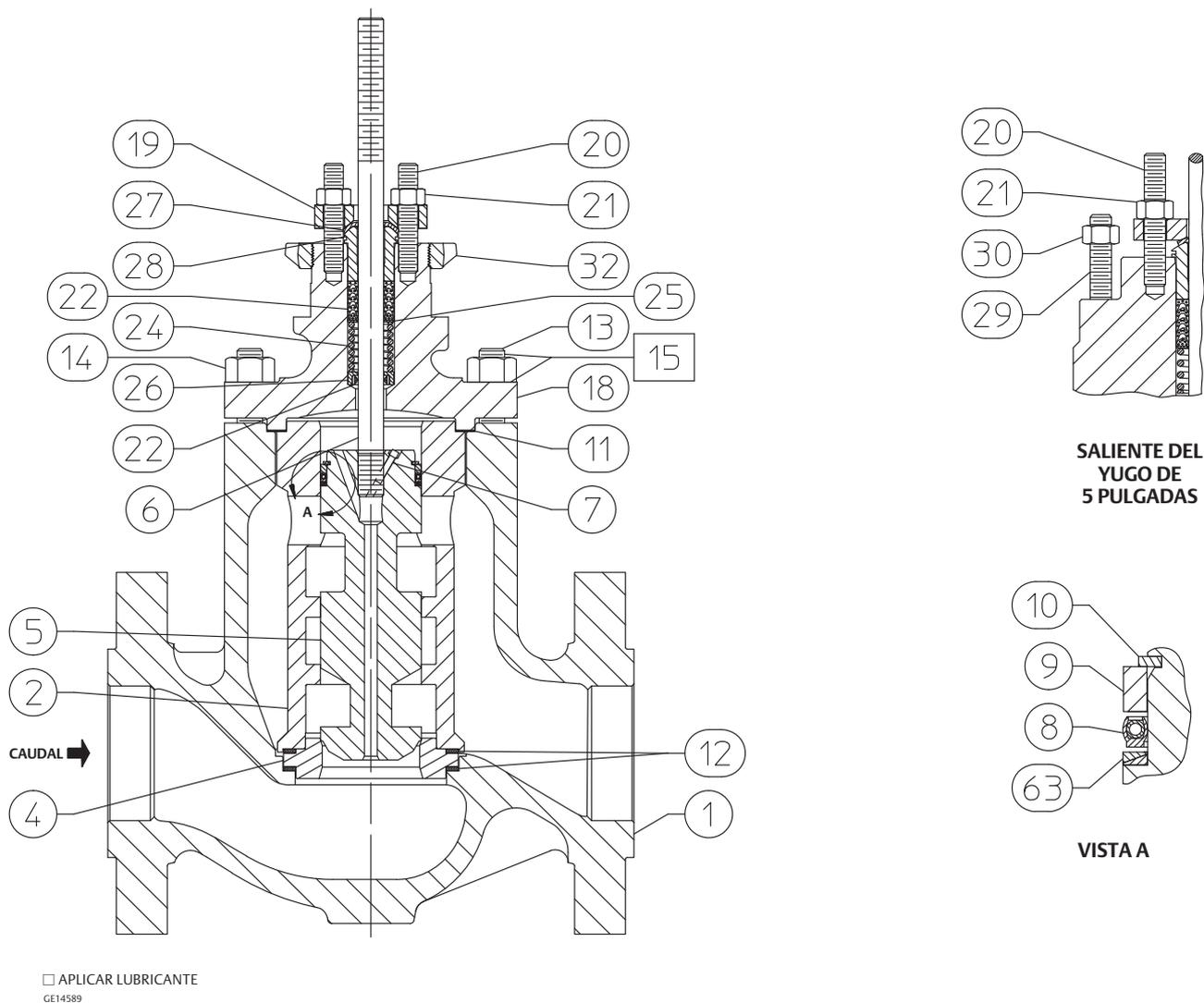
Figura 11. Conjunto de válvula de globo Fisher NotchFlo DST CL900 y 1500 desequilibrada (NPS 1 a 1-1/2)
