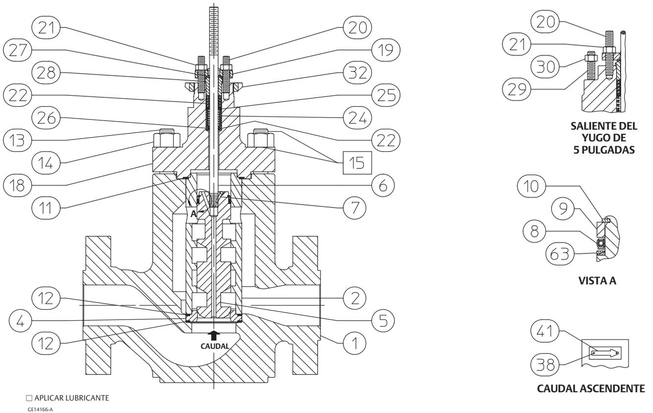
Figura 13. Conjunto de válvula de ángulo Fisher NotchFlo DST CL900 y 1500 desequilibrada (NPS 1 a 1-1/2)
