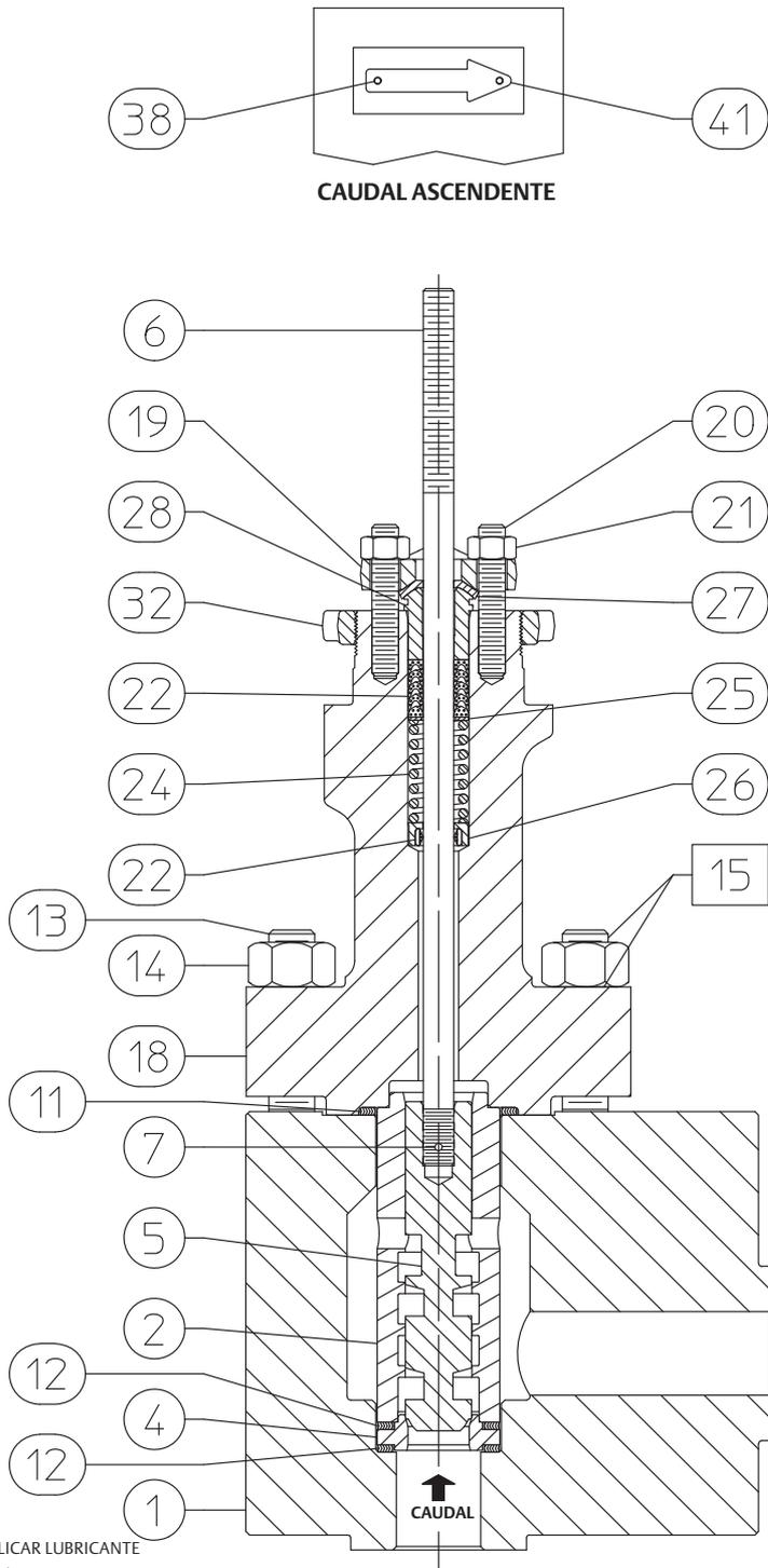
NOTA: LOS CUERPOS DE VÁLVULA DE ÁNGULO DE BLOQUEO NotchFlo FORJADOS UTILIZAN CONEXIONES PERFORADAS Y ROSCADAS DE PERNOS DE BRIDA DE TUBERÍA.
