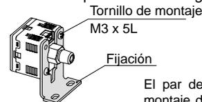
El par de apriete para el tornillo de montaje de la fijación debe ser: 0.5 a 0.7N·m.
