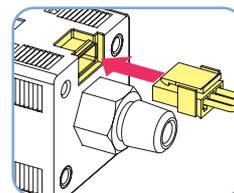
Los conectores enchufables simplifican las tareas de cableado y mantenimiento.
