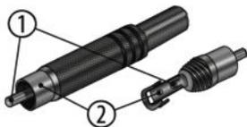
Un conector Cinch se utiliza como entrada LINE para el control de sonido. El esquema y la tabla muestran la asignación de pines.
