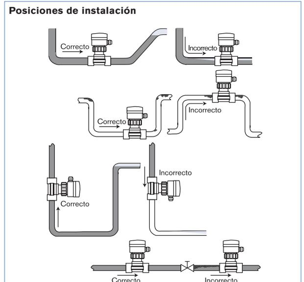
El tamaño de tubería adecuado debe seleccionarse utilizando el diagrama de Caudal/Velocidad/DN. Deben respetarse las presiones y temperaturas nominales del material con que está fabricado el fitting seleccionado.
