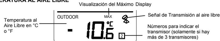
La quinta sección de LCD muestra la temperatura al aire libre y un signo de transmisión. También mostrará un número al lado de la temperatura si se esta usando más de un transmisor.
