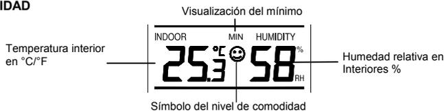
La temperatura y humedad en interiores se visualiza automáticamente en la cuarta sección del LCD.
