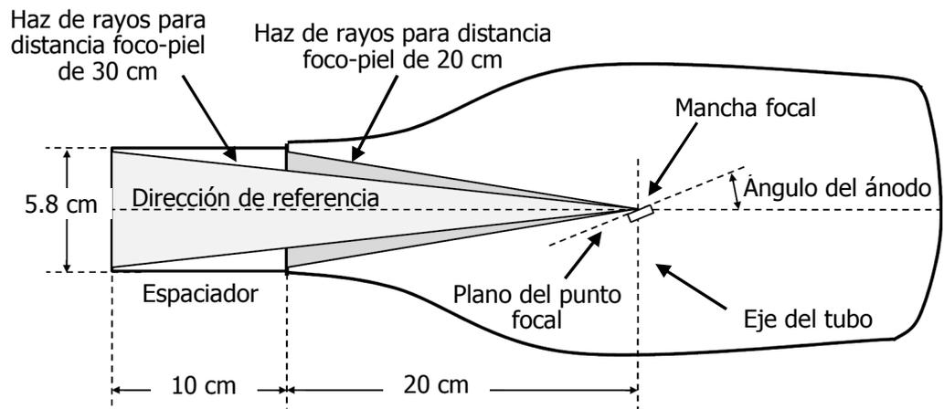
**i** Nota. La posición de la mancha focal está marcada en el exterior del monobloque con un punto en relieve en las cubiertas superior e inferior.
