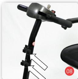
Para ello encontrará la fijación delante en la columna de dirección (Fig. 08). Según las necesidades puede enganchar o desenganchar la cesta de la compra.
