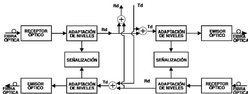
El repetidor N555 consta de dos subsistemas de transmisión y otros dos de recepción. En los de emisión la señal digital a transmitir se convierte de nivel RS-232, RS-422 o RS-485 a nivel TTL para posteriormente, por medio del bloque emisor óptico, modular en intensidad la luz emitida por el elemento conversor utilizado.
