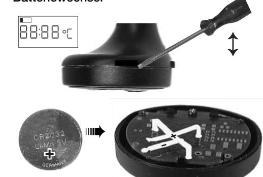
Batteriewechsel wird erforderlich, wenn während der Messung das Symbol in der Anzeige erscheint. Gehäuse mit Hilfe eines Schraubendrehers öffnen. Verbrauchte Knopfzelle herausziehen. Neue Knopfzelle einlegen - **Polung beachten!**
