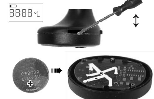
Si le signal apparaît pendant la mesure, les piles doivent être changées. Sortez la pile usagée en la faisant glisser, et remplacez-la par une nouvelle - **Respectez les polarités!**
