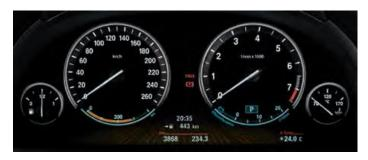
Tablero de instrumentos con tecnología Black-Panel. Cuenta con display de alta definición a color en la parte inferior. Cuando el motor está detenido, la tecnología Black-Panel apaga el tablero dejándolo como una superficie negra mate. Únicamente los aros cromados abiertos hacia abajo se ven de forma tridimensional. Al arrancar el motor, se enciende el tablero, se cierran los aros cromados y reaparecen las escalas y los indicadores.
