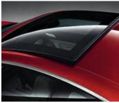
**Techo de cristal eléctrico.** Con función de elevación y cortinilla eléctrica. No cuenta con función deslizable.
