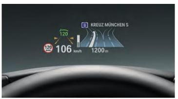
**Head-Up Display a todo color.** Por primera vez, toda la información del Head-Up Display se proyecta a todo color en el campo de visión del conductor, captando las indicaciones aún con más precisión y rapidez mostrando las indicaciones del sistema de navegación, la velocidad en cada momento y las alertas del sistema BMW Night Vision.
