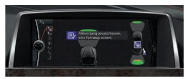
Park Assistant. Ayuda a estacionar el vehículo en paralelo a la calle. El sistema mide los lugares de estacionamiento al pasar junto a ellos a menos de 35 km/h. Una vez que detecta espacio suficiente para estacionarse, controla de manera automática el movimiento del volante y el conductor sólo tiene que acelerar o frenar hasta estacionarse por completo. Los sensores se encuentran integrados en los intermitentes laterales. Equipamiento opcional.
