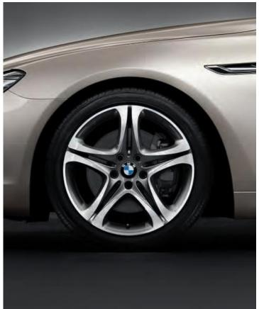
Rines de aleación ligera estilo 367 de 19"\*. Radios en estrella, con neumáticos de distintas medidas y funcionamiento en caso de avería (Runflat), delante 245/40 R19", detrás 275/35 R19".
