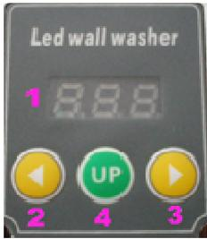
1.- Display Digital, 2.- Cursor desplazamiento izquierda. 3.- Cursor desplazamiento derecha, 4.- Ajustes de datos.
