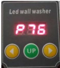
Con el equipo encendido, Presione el botón UP hasta que el display muestre la letra "P", esto significa que está en modo independiente, el segundo código del display muestra la función a programar de acuerdo a la tabla siguiente, (Se puede cambiar la funciones oprimiendo la tecla "UP"). El tercer código del display muestra el brillo o la velocidad del efecto que se está programando (Se puede ajustar la función oprimiendo la tecla "UP")
