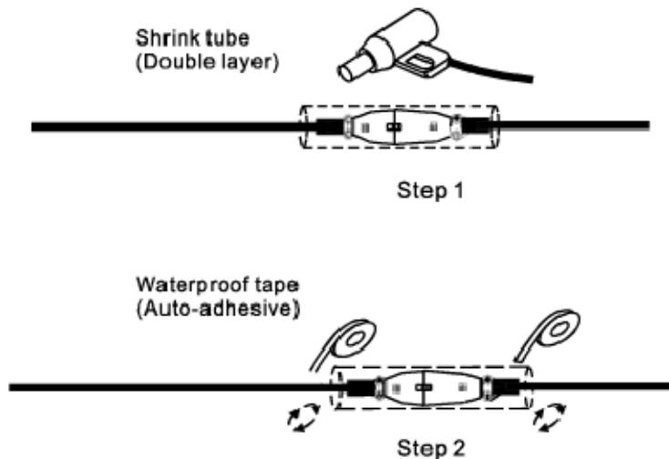
Paso 1: Introducir Cinta termocontractil cubriendo los 2 conectores. Contraer con secadora caliente
