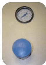
Sistema neumático de ajuste para el tratamiento delicado de diferentes tipos de masa. Puede ajustarse en funcionamiento
