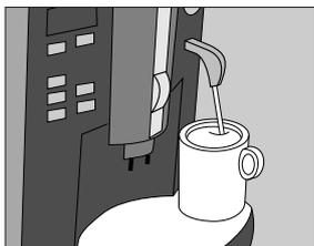
Placer le commutateur sur le symbole "buse". L'automate émet aussitôt de la vapeur.
