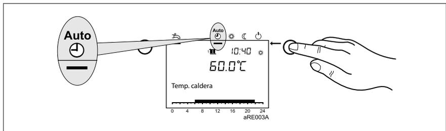
Con la tecla de Servicio de calefacción seleccionar en la unidad de mando de regulación el modo operativo **Funcionamiento automático**.
