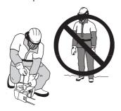
Sujete siempre la motosierra con ambas manos. Agarre la empuñadura trasera con la mano derecha y la empuñadura delantera con la mano izquierda. Todos los usuarios, diestros o zurdos, deben usar este agarre. Agarre con firmeza, con todos los dedos alrededor de las empuñaduras de la motosierra.
