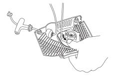
• Afloje el tornillo del centro de la polea y saque ésta. Ponga un cordón nuevo en la polea y fíjelo. Enrolle unas 3 vueltas de cordón de arranque en la polea. Monte la polea contra el muelle de retorno de forma que el extremo del muelle enganche la polea. Ponga el tornillo en el centro la polea. Pase el cordón por el orificio del cuerpo del mecanismo de arranque y la empuñadura de arranque. Haga un nudo resistente en el cordón.
