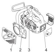
Limpie el sistema refrigerante con un cepillo una vez por semana (en condiciones difíciles, con mayor frecuencia). Un sistema refrigerante sucio u obturado produce sobrecalentemiento de la máquina, con las consiguientes averías del cilindro y el pistón.
