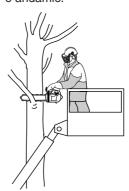
8 Para cortar con la parte superior de la espada, en sentido ascendente desde la parte inferior del objeto a cortar, proceda con muchísimo cuidado. Al trabajar con esta técnica, llamada de cadena impelente, la cadena empuja la motosierra hacia atrás, hacia el usuario. Si la cadena de sierra se atasca, la motosierra puede ser lanzada hacia atrás contra usted.
