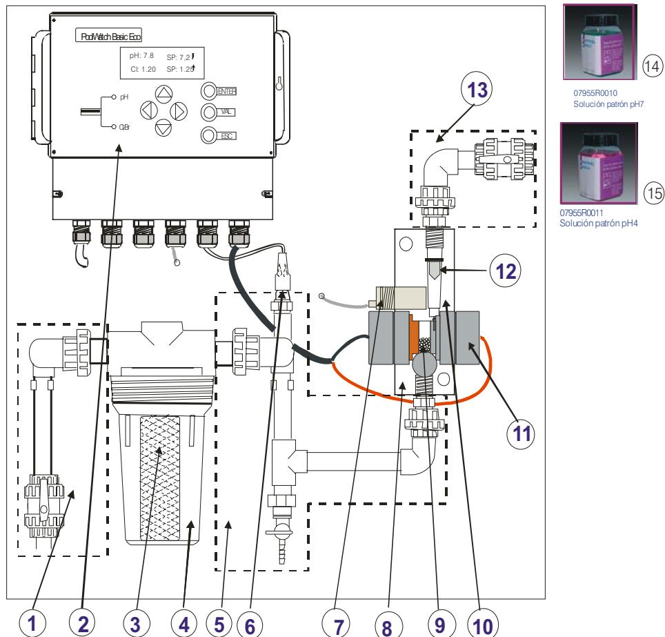
**Nota:** Las bolas autolimpiables (28471R0103), la cámara de análisis (28471R0102), el ánodo soluble de cobre (28471R0101), y el flotador de inoxidable son componentes de la célula galvánica (28471R01 02).
