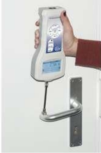
Dinamómetro de precisión serie PCE-FB con una célula de carga interna para las fuerzas de tracción y compresión.
