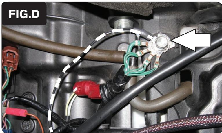
10. Unir el cable de masa del SFM a la masa de serie, debajo del depósito de la gasolina (Fig. D).
