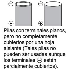
Pilas con terminales planos, pero no completamente cubiertos por una hoja aislante (Tales pilas no pueden ser usadas aunque los terminales  $\ominus$  estén parcialmente cubiertos).
