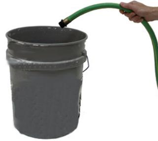
2. L'alimentation en eau doit être au moins 125% de la capacité de débit de la pompe. Le débit d'alimentation peut être mesuré en calculant le temps nécessaire pour remplir un contenant de cinq gallons (19 litres). Par exemple, celui-ci se remplira en 5/3 minutes (100 secondes) lorsque le débit est de 3.0 gal/min.
