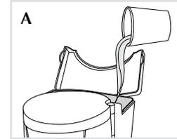
1. Abra la tapa del tanque y vierta agua fría hasta el nivel de llenado que indica 12 tazas (A). No sobrellenar.
