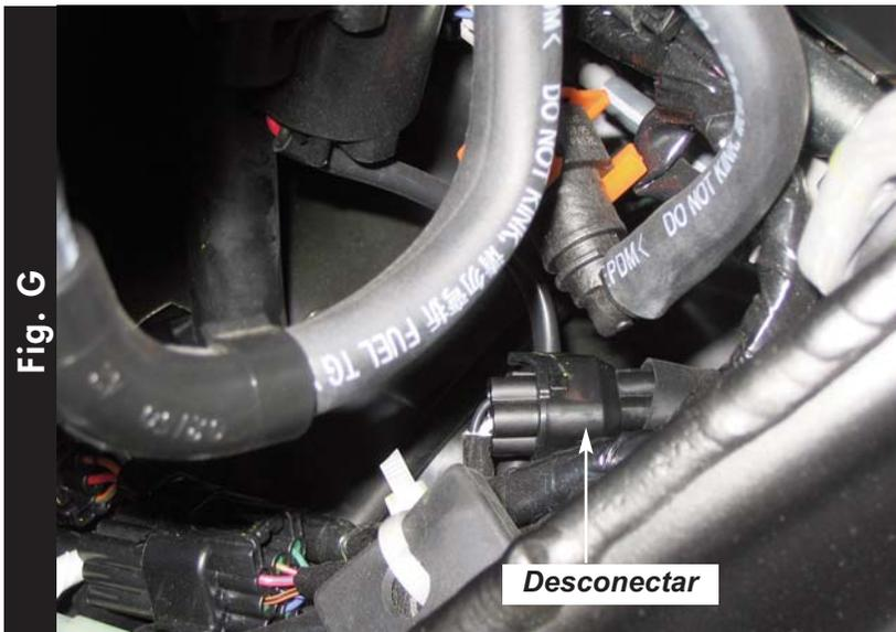
10. Localizar el conector del sensor de O2 de serie.
