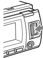
**2 Conecte el iPod al terminal USB mediante el conector de acoplamiento “Dock” al cable USB.**
