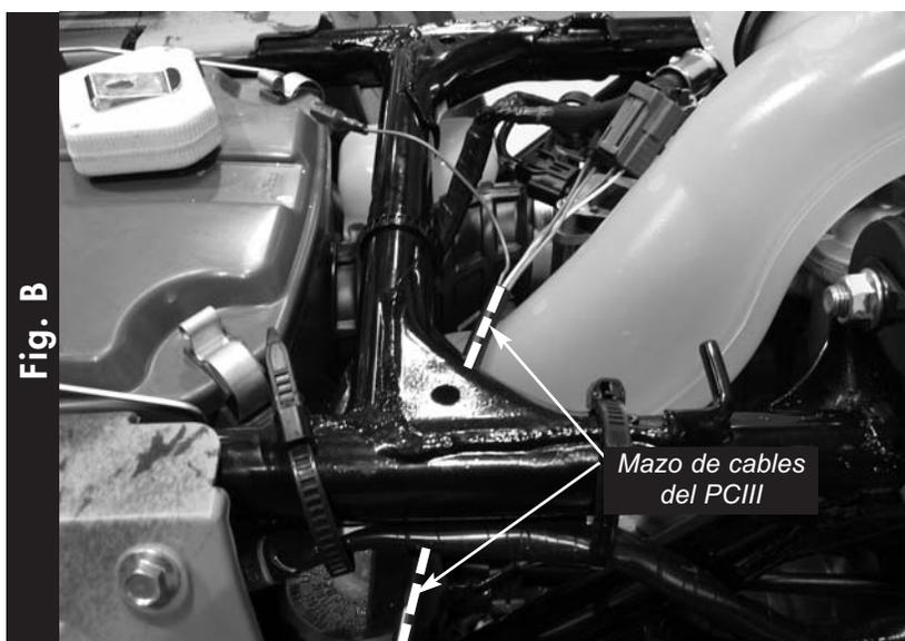
3. Hacer pasar el mazo de cables del PCIII desde el lateral derecho del quad, por encima del depósito del freno trasero y por debajo del chasis (Fig. B).
