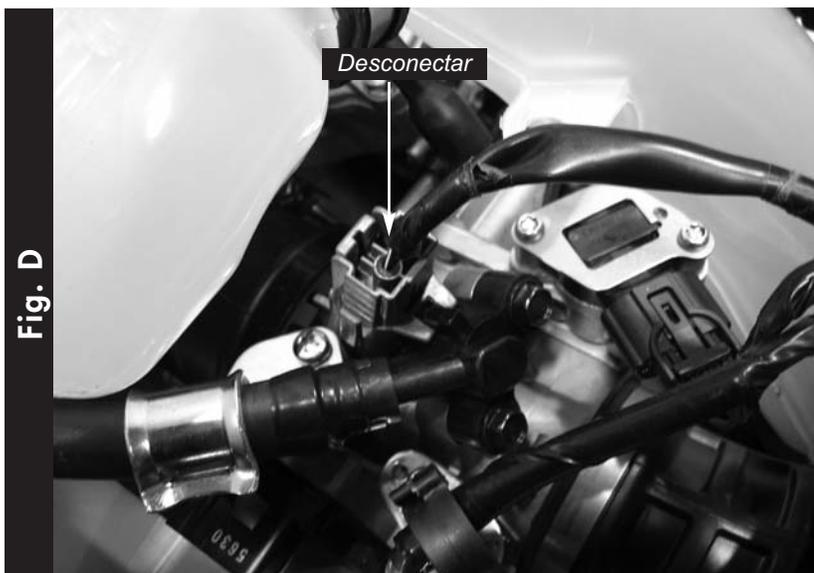
5. Desconectar el mazo de cables de serie del inyector (Fig. D).
