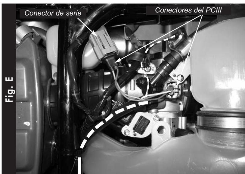
6. Conectar el mazo de cables del PCIII en línea con el inyector y el mazo de cables de serie (Fig. E).
