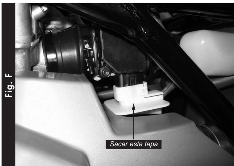
8. Sacar el capuchón blanco que cubre el conector del Sensor de Posición del Acelerador (Fig. F) El TPS está situado a la izquierda del cuerpo del acelerador.
