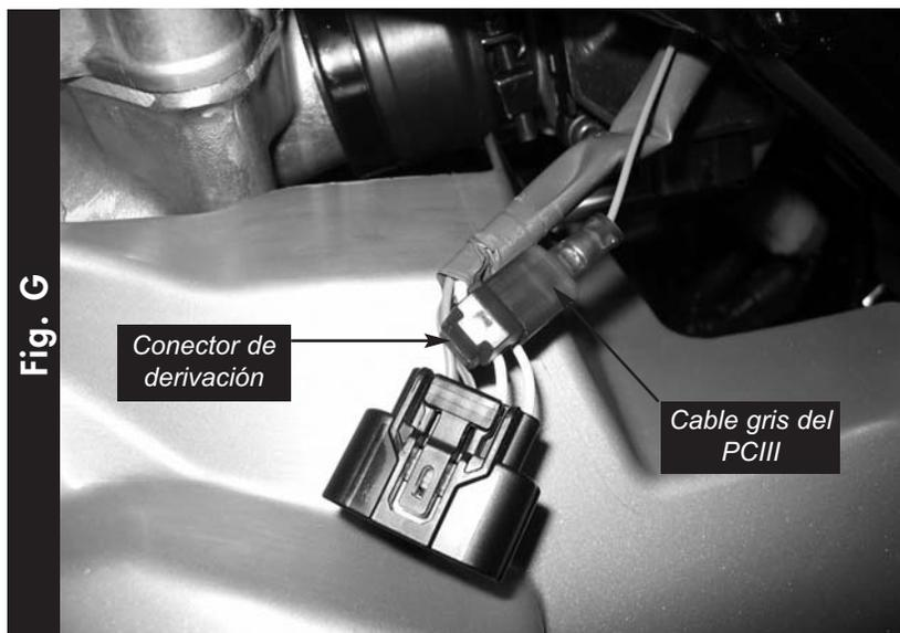
10. Unir el conector de derivación que se suministra al cable AMARILLO del mazo de cables del TPS (Fig. G). Comprobar que el conector de derivación queda completamente cerrado.
