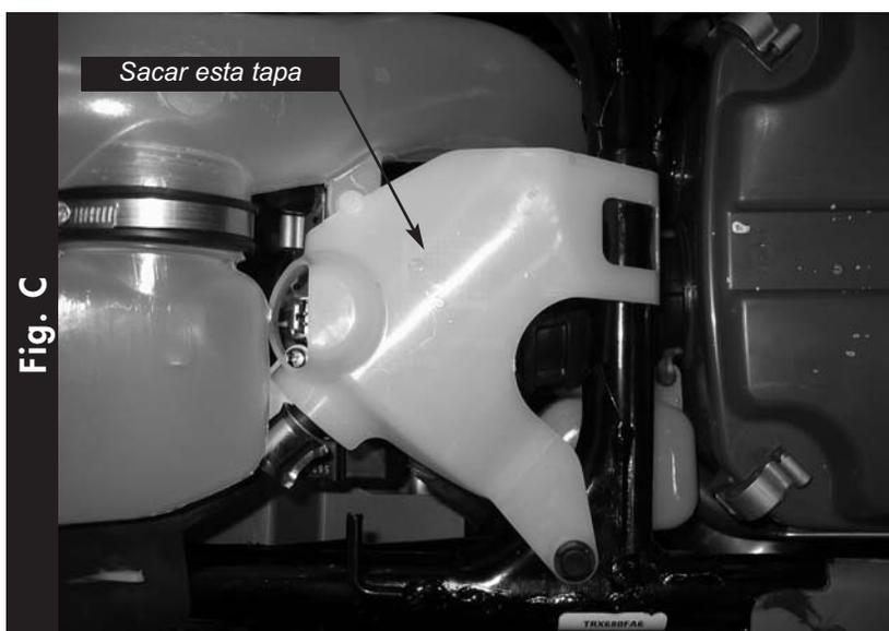
4. Desmontar la tapa blanca que está sobre el cuerpo del acelerador soltando el pasador de sujeción (Fig. C) Esta tapa está situada delante de la caja de aire (airbox).
