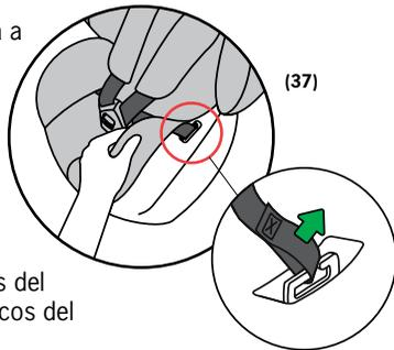
3- Se puede quitar la cubierta del apoya cabeza por separado, desconectando los ganchos de la parte posterior y tirando de la tela hacia adelante.
