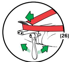
11- Ajuste el gancho guía del cinturón hacia afuera con el trinquete (26). Continúe ajustando hasta que el asiento quede bien presionado en el respaldo del asiento del vehículo. Mueva el apoya cabeza en la posición correcta (consulte "Posicionamiento del niño" en la página 17). Ahora, el asiento está listo para usar.
