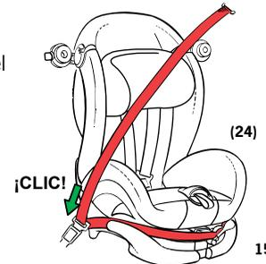
8- Coloque el cinturón de hombro a través de las trabas del cinturón. Asegúrese de que el cinturón no esté torcido (25).
