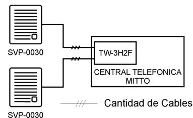
*La instalación debe realizarse con la central apagada y desconectada de la red eléctrica*
