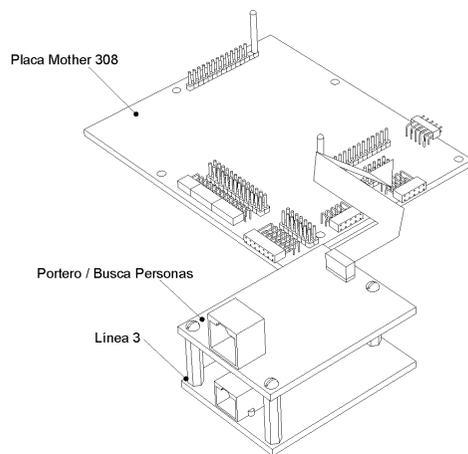
Se coloca con las torretas sobre la línea 3 y se conecta a la mother con el cable TW-CP3.
