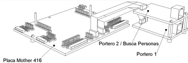
**Portero 1 (58):** Se conecta a la mother con el cable TW-CP4 como se indica en el dibujo.
