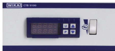
Fig. 11: Parte frontal del regulador con rueda para la velocidad de agitación
