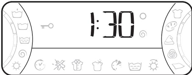
Az után, hogy a program elindításához megnyomta a START/RESET billentyűt, a kijelzőn a ciklus végéig hátralévő idő látható. Abban az esetben, ha az indító órán késleltetés van beállítva (Késleltetés időzítő, lásd 55. oldal) ezt megjeleníti.
