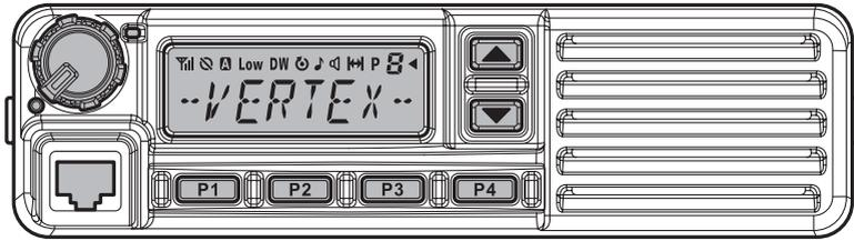
Los dispositivos de la serie **VX-2200E** son completos transceptores FM diseñados para las comunicaciones empresariales de estación de base y móviles en las bandas móviles terrestres VHF y UHF. Este transceptor ha sido diseñado para ofrecer una comunicación empresarial fiable en distintas aplicaciones con una gran variedad de funciones, gracias a su diseño de vanguardia.
