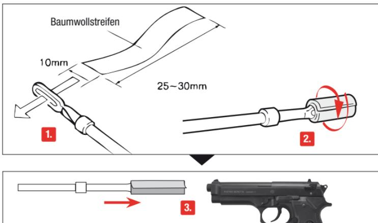
Sichern Sie die Waffe. Nehmen Sie einen ca. 30 cm dicken, langen Stab. Wickeln Sie ein Stück Baumwolttuch um das Ende, benetzen Sie das Tuch mit etwas Waffen-Öl und reinigen Sie damit den Lauf.
