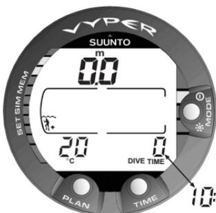
Fig. 3.4. Pantalla puesta en marcha IV. Pantalla superficie: la profundidad y el tiempo de inmersión están a cero (aún no se ha realizado ninguna inmersión) y la temperatura es de 20°C.
