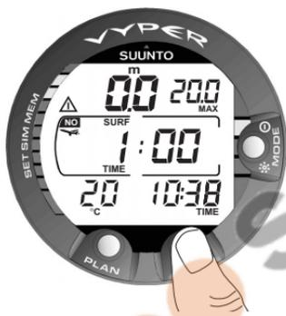
**Fig. 3.28. Pantalla superficie, hora.** El intervalo en superficie y la hora actual se visualizan pulsando una vez el botón TIME.
