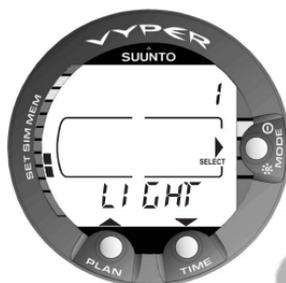
Fig. 4.41. Ajustes de la iluminación [1 LIGHT].
