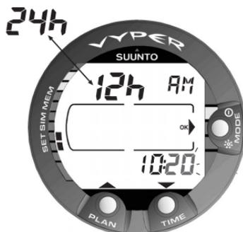
Fig. 4.35. Ajuste del formato de hora y de la hora.
