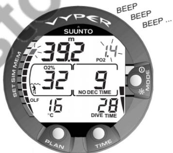
Fig. 3.23. Visualización de la presión parcial de oxígeno y del indicador OLF. Cuando la presión parcial de oxígeno supera los 1,4 bar o el parámetro seleccionado, y el indicador OLF alcanza el 80 %, se dispara una alarma acústica.
