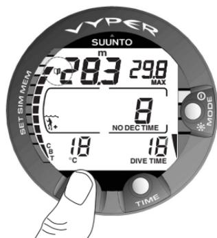
Fig. 3.9. Visualización durante la inmersión. Se ha señalado un marcador en la memoria del perfil de inmersión durante la inmersión pulsando el botón PLAN (se visualiza el símbolo del diario de buceo).
