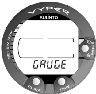
Fig. 3.3. Pantalla puesta en marcha III. Utilización en modo profundímetro.
