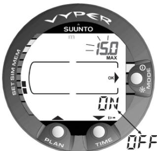
Fig. 4.30. Ajuste de la Alarma de Profundidad Máxima.
