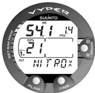
**Fig. 3.20. Pantalla Nitrox.** La profundidad máxima basada en los ajustes  $O_2$  (21%) y  $PO_2$  (1.4 bar) es de 54,1 m (177 pies).
