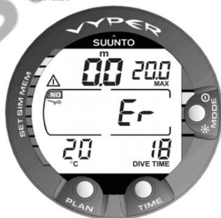
**Fig. 3.30. Pantalla superficie después de una inmersión en la que no se han respetado los procedimientos de descompresión.** La abreviación Er indica que la profundidad tope ha sido superada durante más de tres minutos. No bucear durante un mínimo de 48 horas.
