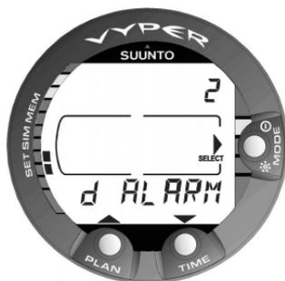
Fig. 4.27. Alarma del tiempo de inmersión (2 d ALARM)
