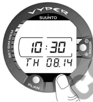
Fig. 2.1. Pantalla reloj. Se visualiza esta pantalla pulsando los botones PLAN o TIME.
