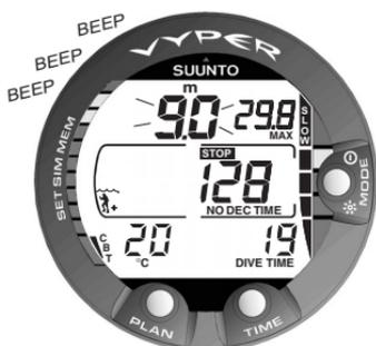
**Fig. 3.13. Indicador de velocidad de ascenso.** La profundidad actual parpadea, se visualiza la indicación SLOW y cuatro segmentos: la velocidad de ascenso es superior a 10 m/min. Es necesario reducir la velocidad. La señal STOP significa que se debe realizar una parada de seguridad obligatoria cuando alcance una profundidad de 6 m.
