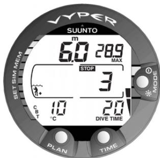
Fig. 3.10. Indicador de la velocidad de ascenso. Dos segmentos
