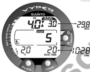
**Fig. 3.14. Parada de seguridad obligatoria.** Debe efectuar una parada de seguridad obligatoria en la zona de profundidad entre 6 m y 3 m. Puede acceder a la visualización alternativa pulsando el botón TIME.
