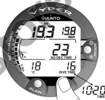
Fig. 3.8. Visualización durante la inmersión. La profundidad actual es de 19,3 m; el tiempo de inmersión sin descompresión es de 23 minutos en modo A0/P1. La profundidad máxima alcanzada durante la inmersión es de 19,8 m; el tiempo de inmersión es de 16 minutos y la temperatura de 18°C. La hora, 10:20, se visualiza durante 5 segundos pulsando el botón TIME.
