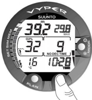
**Fig. 3.24. Visualización alternativa.** Visualice en pantalla la hora actual, la profundidad máxima y el nivel de saturación, pulsando el botón TIME.
