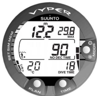
Fig. 3.11. Indicador de la velocidad de ascenso. Tres segmentos
