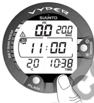
**Fig. 3.29. Pantalla superficie, tiempo de espera antes de un desplazamiento aéreo.** Se visualiza el tiempo de espera antes de realizar un desplazamiento aéreo, indicado por el símbolo de avión, pulsando dos veces el botón TIME.
