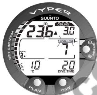
**Fig. 3.16. Inmersión con descompresión, por debajo de la profundidad base.** La flecha hacia arriba y el indicador intermitente ASC TIME recomiendan ascender. El tiempo total de ascenso mínimo, incluida la parada de seguridad, es de 7 min. La profundidad tope es de 3 m.
