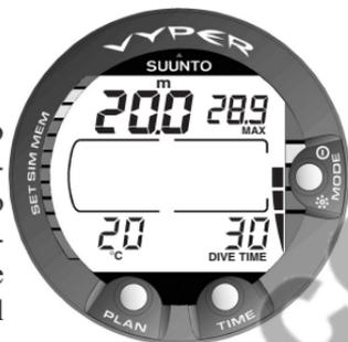
Fig. 3.26. Utilización como profundímetro durante la inmersión.
