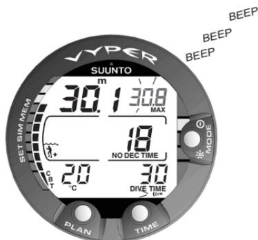
Fig. 3.33. Se activa la alarma de profundidad máxima.
