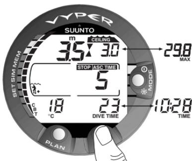
**Fig. 3.18. Inmersión con descompresión, en la zona tope (zona de desaturación óptima).** Las dos flechas están frente a frente. El buceador está en la zona de descompresión óptima a 3,5 m y el tiempo total de ascenso mínimo es de 5 min. Se pueden visualizar la profundidad máxima y la hora pulsando el botón TIME.
