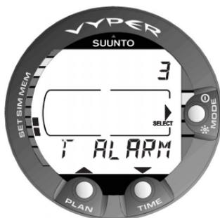
Fig. 4.38. Los ajustes de la alarma diaria [3 T ALARM].
