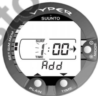
Fig. 4.20. Simulación de un intervalo en superficie. Ajuste el intervalo en superficie con los botones TIME (6) y PLAN (5). NOTA : El intervalo en superficie sólo se visualiza en caso de inmersiones sucesivas.
