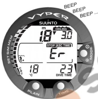
**Fig. 3.19. Inmersión con descompresión, por encima de la profundidad tope.** Observe la flecha hacia abajo y la indicación de error ER. La alarma acústica se dispara. Es necesario volver a descender inmediatamente (en un tiempo máximo de 3 min.) a la profundidad tope o por debajo de ésta.
