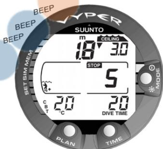
**Fig. 3.15. No se ha respetado la parada de seguridad obligatoria.** Es necesario descender de nuevo a la profundidad señalada junto a la indicación CEILING.
