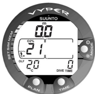
**Fig. 3.21. Pantalla superficie** en utilización como ordenador NITROX.
