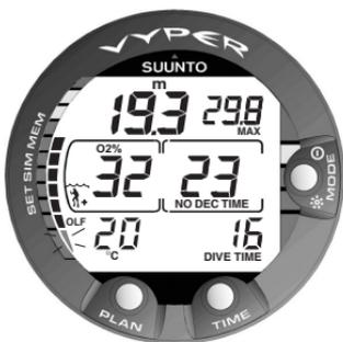
**Fig. 3.25** La OTU alcanza el límite de toxicidad SNC. El segmento inferior comienza a parpadear.
