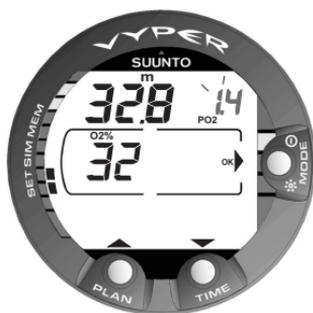
Fig. 4.32. Ajuste del porcentaje y de la presión parcial de oxígeno. La profundidad máxima autorizada es de 32,8 m. Pulse los botones de desplazamiento para cambiar el porcentaje de oxígeno y para fijar el valor del límite parcial de oxígeno.
