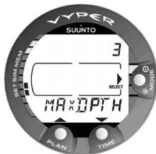
Fig. 4.29. Alarma de profundidad máxima. [3 MAX DEPTH].
