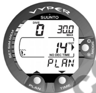
**Fig. 3.6. Planificación de inmersiones.** La planificación está señalada por la indicación PLAN. El tiempo disponible sin descompresión a 30 m es de 14 minutos en modo A0/P1.
