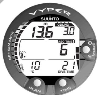
**Fig. 3.17. Inmersión con descompresión, por encima de la profundidad base.** La flecha desaparece y la indicación ASC TIME ya no parpadea. El buceador está en la zona de descompresión.
