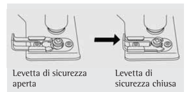
Premere l'adattatore di connessione sulla cartuccia
