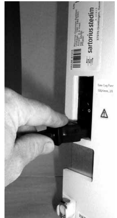
Raccord de la fiche secteur sur le côté gauche de l'appareil
