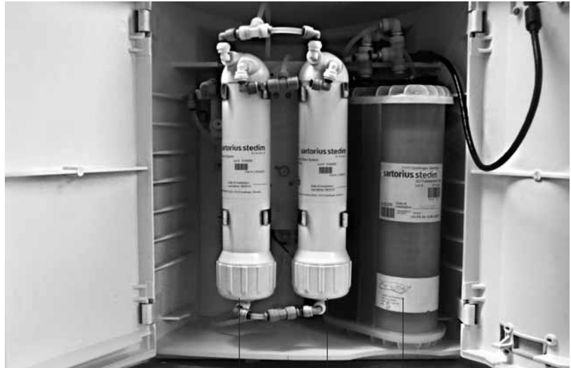
RO-Module bei geöffneter Gerätetür
