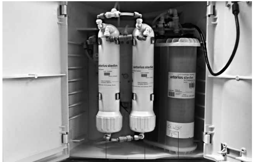
Módulos RO con la puerta abierta
