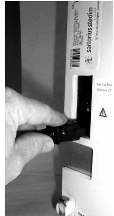
Attacco per il cavo di rete, lato sinistro dell'apparecchio
