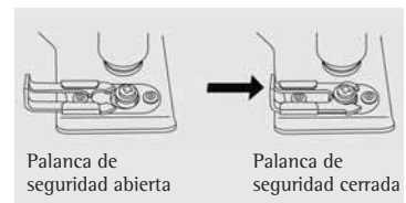
Presionar el adaptador de conexión sobre el cartucho
