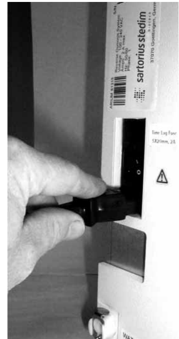
Anschluss für den Netzstecker, linke Geräteseite
