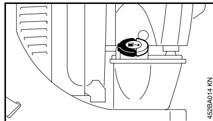
Use solamente el aceite STIHL para motores de dos tiempos o un aceite de marca equivalente para motores de dos tiempos diseñado para usar exclusivamente con los motores de dos tiempos enfriados por aire.
