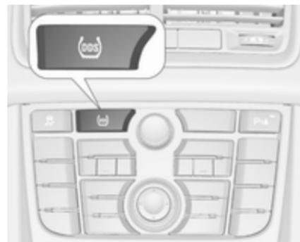
Después de corregir la presión de los neumáticos o cambiar una rueda, debe inicializarse el sistema: Conecte el encendido y mantenga pulsado el botón **DDS** durante unos 4 segundos.
