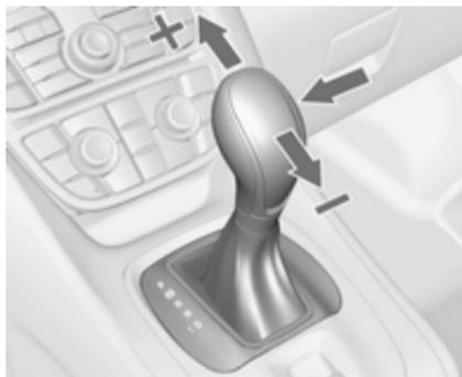
Mueva la palanca selectora desde la posición **D** hacia la izquierda y luego hacia delante o hacia atrás.
