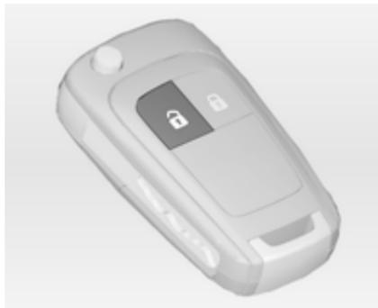
Con el encendido desconectado, pulse el botón
