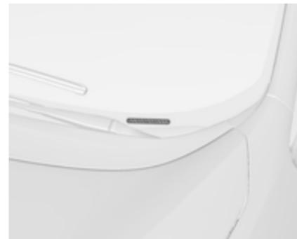
El número de identificación del vehículo también puede ir estampado en el tablero de instrumentos, visible a través del parabrisas.
