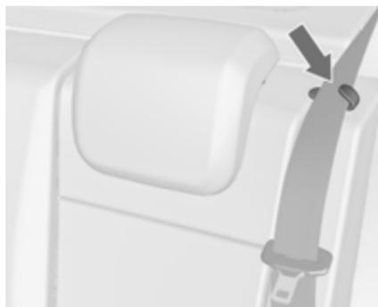
Extraiga el cinturón de seguridad del clip de sujeción en el respaldo.
