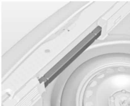
Guarde el triángulo de advertencia en el espacio situado en la parte trasera del compartimento de carga.
