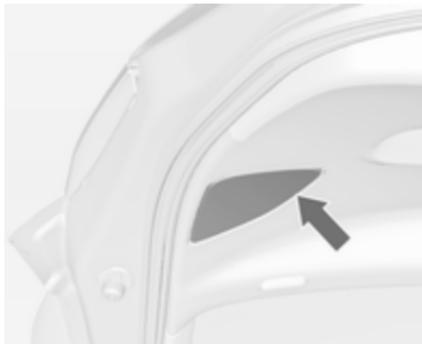
1. Abra el portón trasero y desmonte la tapa con un destornillador.
