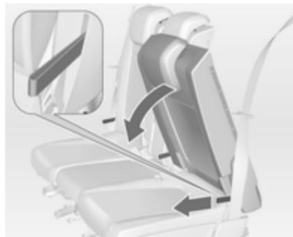
Tire del asidero en la parte delantera del respaldo y abata el respaldo sobre la banqueta de asiento. El asiento se rebaja automáticamente.
