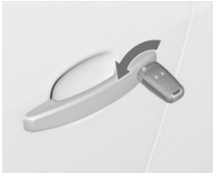
Desbloquee manualmente la puerta del conductor girando la llave en la cerradura. Conecte el encendido y pulse el botón del cierre centralizado para desbloquear todas las puertas, el compartimento de carga y la tapa del depósito de combustible. Al conectar el encendido, se desactiva el seguro antirrobo. ↪ 27.
