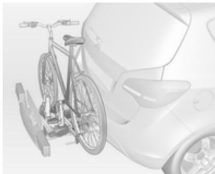
El portabicicletas trasero (sistema Flex-Fix) ofrece la posibilidad de fijar bicicletas en un soporte extraíble integrado en el piso del vehículo.
