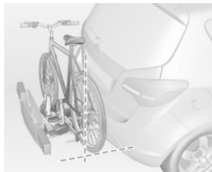
Alínee la bicicleta en la dirección longitudinal del vehículo: Afloje un poco el soporte del pedal.
