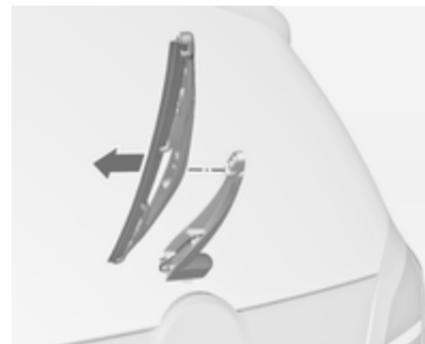
Levante el brazo del limpiaparabrisas. Desacople la escobilla del limpiaparabrisas tal y como se indica en la ilustración y desmóntela.
