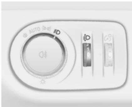
Para adaptar el alcance de los faros a la carga del vehículo y evitar el deslumbramiento: gire la rueda de ajuste
