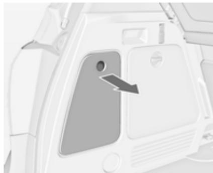
La caja de fusibles está en el lado izquierdo del compartimento de carga, detrás de una tapa. Desmonte la tapa.
