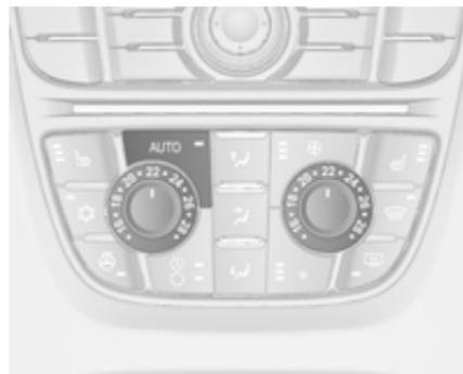
Si se ajusta la temperatura mínima, el climatizador automático funciona a la máxima potencia de refrigeración.
