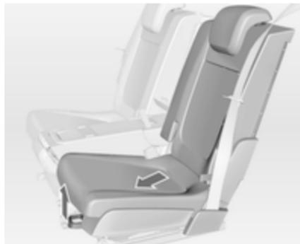
Tire de la manilla y deslice el asiento transversalmente hacia delante hasta la posición 2. El asiento es guiado automáticamente hacia fuera. Suelte la manilla y deje que el asiento se enclave en su posición.
