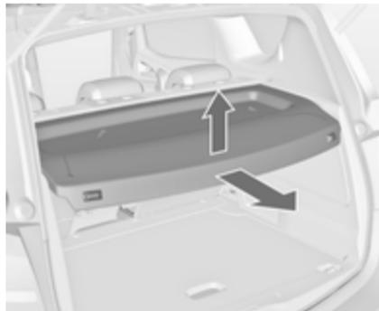
Levante la cubierta por la parte trasera y empújela hacia arriba por la parte delantera.
