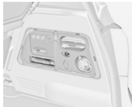
Las herramientas del vehículo están en el compartimento derecho, en el compartimento de carga, junto con el juego de reparación de neumáticos.
