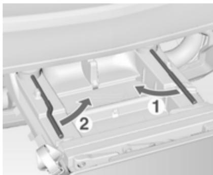
Basculen las palancas tensoras, primero la derecha (1) y luego la izquierda (2), hasta que note una resistencia.
