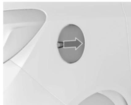
La tapa del depósito sólo se puede abrir con el vehículo desbloqueado. Tire de la tapa por el rebaje y ábrala.
