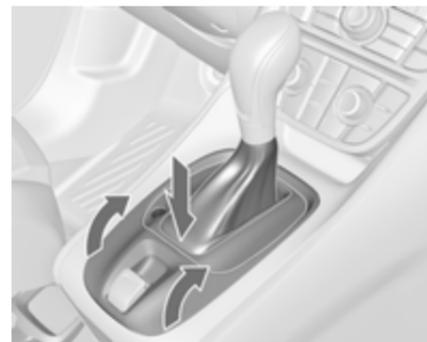
2. Agarre el revestimiento de la palanca selectora por la posición marcada y tire para desenclavarlo de la parte posterior.
