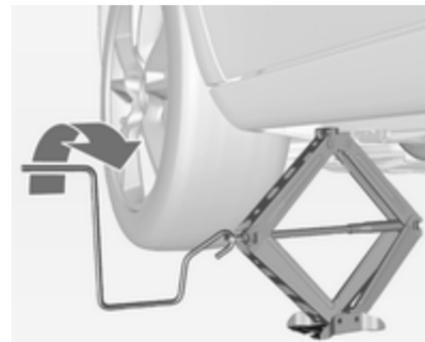
Acople la manivela del gato y, con el gato correctamente alineado, gire la manivela hasta que la rueda se despege del suelo.
