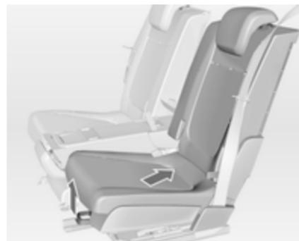
Tire de la manilla y deslice el asiento transversalmente hacia atrás hasta la posición 1. El asiento es guiado automáticamente hacia dentro. Suelte la manilla y deje que el asiento se enclave en su posición.
