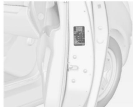
Presión de los neumáticos ⇨ 210 y en la etiqueta colocada en la puerta del acompañante.
