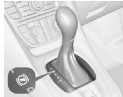
Si el pedal del freno no está pisado, se enciende el testigo de control (Ⓢ).
