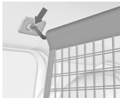
Hay dos aberturas de montaje en el marco del techo: enganche la varilla de la red en un lado, presione hacia delante y enclávela. Extienda la varilla, engánchela en el otro lado, presione hacia delante y enclávela.
