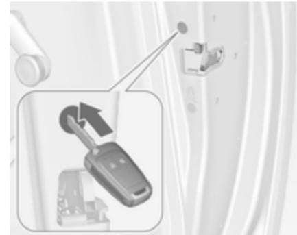
Inserte la llave en la abertura situada encima de la cerradura, en el interior de la puerta, y accione el bloqueo presionando hasta que haga clic. Luego cierre la puerta. El procedimiento debe realizarse para cada puerta. La puerta del conductor también se puede bloquear desde el exterior con la llave. La tapa del depósito de combustible y el portón trasero no se pueden bloquear.
