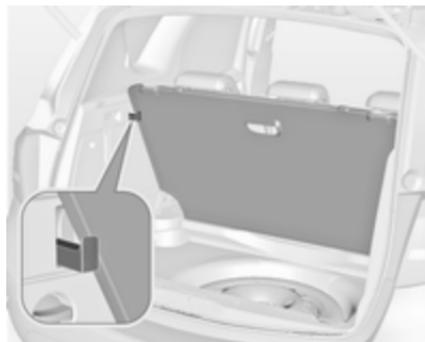
La cubierta del piso trasero se puede levantar.
