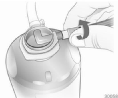
2. Desacople el tubo flexible del soporte y enrósquelo en la conexión del bote de sellador.
