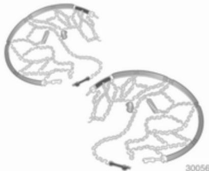
Sólo se pueden utilizar cadenas en las ruedas delanteras.
