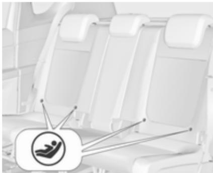
Fije los sistemas de retención infantil ISOFIX homologados para el vehículo a los soportes de montaje ISOFIX. Las posiciones específicas del vehículo para los sistemas de retención infantil ISOFIX están marcadas mediante "IL" en la tabla.
