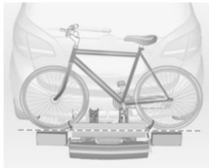
Coloque los alojamientos de las ruedas de forma que la bicicleta quede más o menos horizontal. La separación entre los pedales y el portón trasero debería ser de 5 cm como mínimo.
