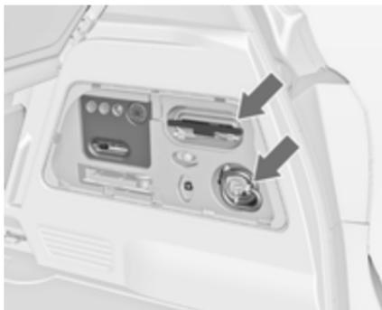
1. Saque el bote de sellador y el soporte con el tubo flexible de aire del suplemento.
