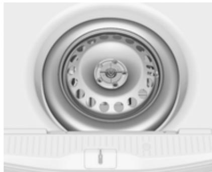
La rueda de repuesto está situada en el compartimento de carga, debajo de la cubierta del piso. Está fijada con una tuerca de mariposa.
