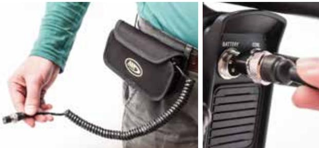
En caso de que quiera llevar las baterías con usted, retire las correas de la cubierta del encaje y fíjelo a su cinturón. Inserte la caja de la batería en el zócalo de la batería bajo el sistema de caja y fíjelo apretando.
