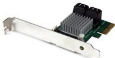
La tarjeta controladora PCI Express 2.0 SATA de 4 puertos, con HyperDuo, modelo PEXSAT34RH, permite agregar 4 puertos AHCI SATA III a un ordenador a través de una ranura PCIe (x2), y ofrece varias conexiones internas de 6 Gbps con unidades de disco duro de alto rendimiento, así como unidades SSD ("Solid State Drives", unidades de estado sólido).
