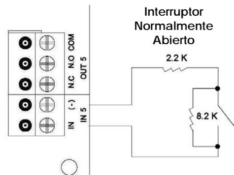
Figura 4 Entradas Normalmente Abiertas bajo Supervisión de Doble Resistencia
