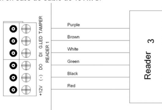
Figura 7 Instalación Eléctrica para Lector 3
