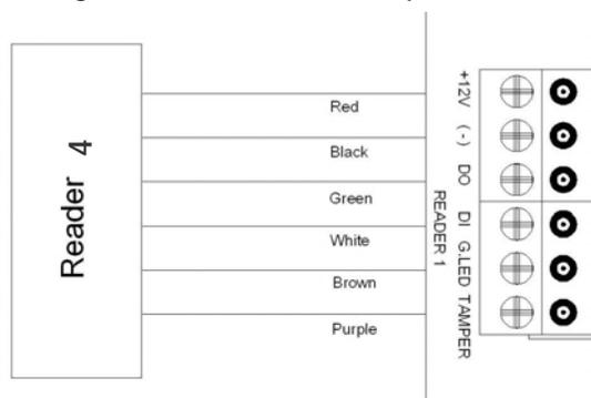
Figura 8 Instalación Eléctrica para Lector 4
