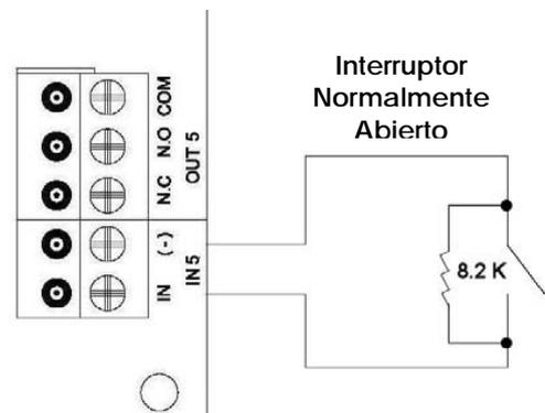
Figura 3 Entradas Normalmente Abiertas bajo Supervisión de Resistencia Única
