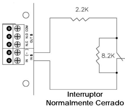
Figura 6 Entrada Normalmente Cerrada bajo Supervisión de Doble Resistencia
