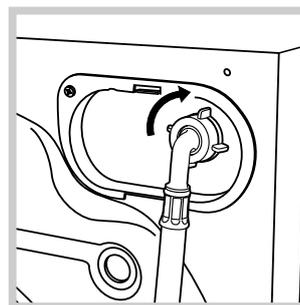
2. Conecte el tubo de alimentación a la máquina enroscándolo en la toma de agua correspondiente ubicada en la parte posterior derecha (arriba) (ver la figura).
