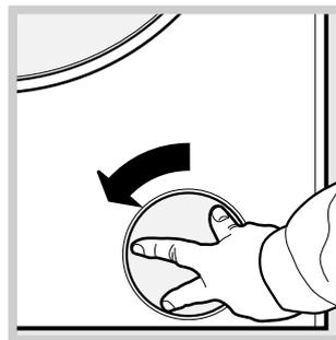
1. remova a protecção situada na parte baixa da máquina de lavar roupa, girando-a no **sentido anti-horário** (veja a figura);
