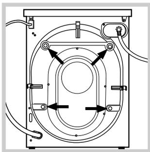
3. Tire os 4 parafusos de protecção para o transporte e a borrachinha com o respectivo calço, situados na parte traseira (veja a figura).
