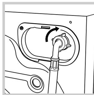
2. Collegare il tubo di alimentazione alla macchina avvitandolo all'apposita presa d'acqua, nella parte posteriore in alto a destra (vedi figura).
