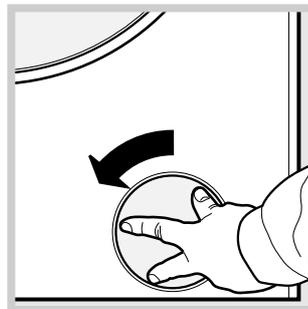
1. rimuovere la protezione posta nella parte bassa della lavabiancheria, ruotandola in **senso antiorario** (vedi figura);
