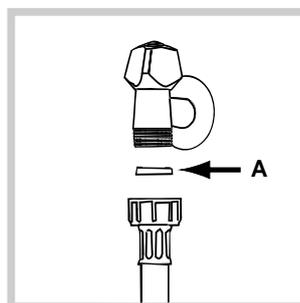
1. Introduzca la junta A en el extremo del tubo de alimentación y enrósquelo a un grifo de agua fría con boca roscada de 3/4 gas (ver la figura). Antes de conectarlo, haga correr el agua hasta que esté limpia.
