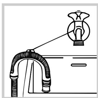
ou coloque na beira de um lavabo ou de uma banheira, prenda na torneira a guia fornecida (veja a figura). A ponta solta do tubo de descarga não deve permanecer imersa na água.
