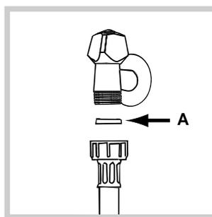
1. Coloque a guarnição A na ponta do tubo de alimentação e atarraxe-o numa torneira de água fria com bocal de rosca de 3/4 gás (veja a figura). Antes de realizar esta ligação, deixe a água escorrer até estar límpida.
