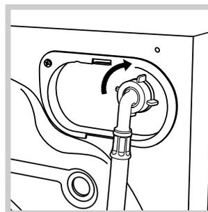
2. Ligue o tubo de alimentação na máquina de lavar roupa atarraxado no apropriado fornecimento da água, na parte traseira, em cima à direita (veja a figura).
