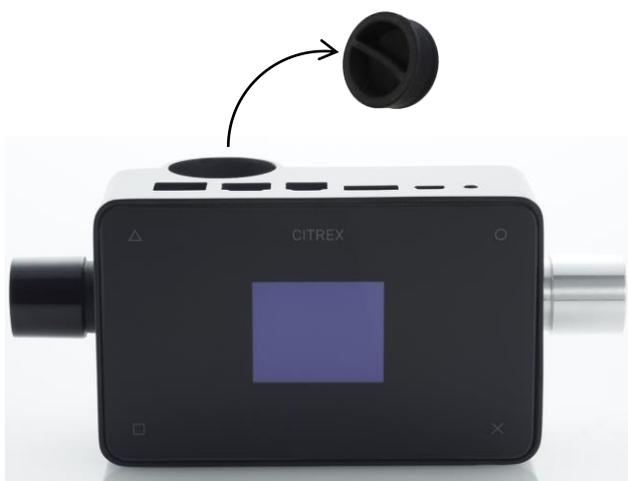
Coloque el sensor de O<sub>2</sub> girándolo en el sentido horario y conecte el sensor con el aparato mediante el cable del sensor.
