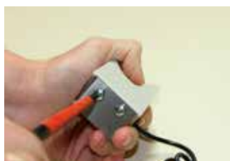
1. Afloje los 2 tornillos situados en la parte trasera del soporte de la sonda.
