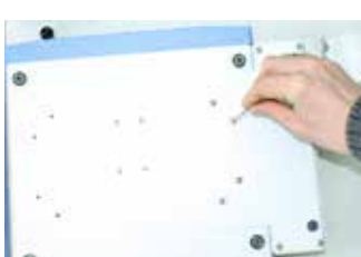
12. Fije el iHandle a la carcasa del Diagnostic Cube
