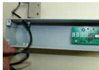
6. Introduzca el cable a través del orificio del iHandle
