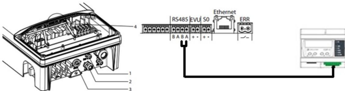
**Figura 1:** Conexión entre un CDP y un único inversor.
