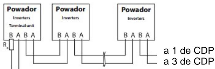
**Figura 3:** Conexión entre un CDP y varios inversor.
