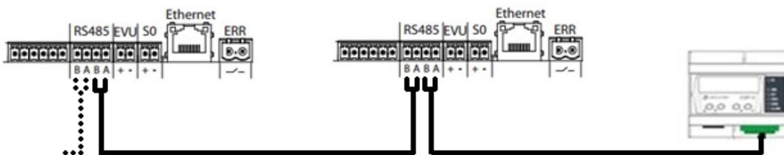
**Figura 2:** Conexión entre un CDP y varios inversor.
