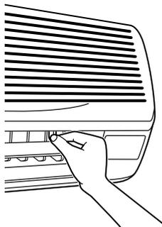
Detenga las aletas horizontales a una posición en la que puede mantenerlas y ajustar las pestañas a izquierda y derecha.
