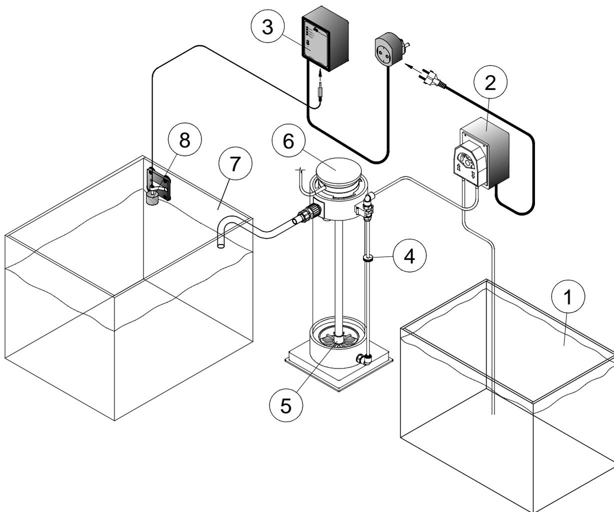
**Fig.2 Instalación del reactor de kalkwasser en el acuario**
