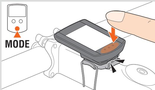
Cuando el computador esté instalado en el soporte, una vez que presione la sección de puntos de la unidad, se presionará el botón **MODE**.
