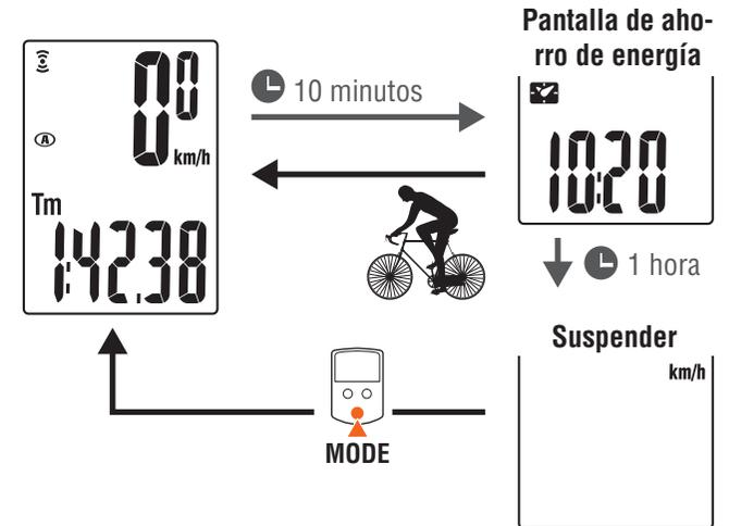
Si transcurren otros 60 minutos de inactividad en el modo de ahorro de energía, solamente la unidad de velocidad se mostrará en la pantalla. En esta pantalla, al pulsar el botón **MODE** se regresará a la pantalla de mediciones.
