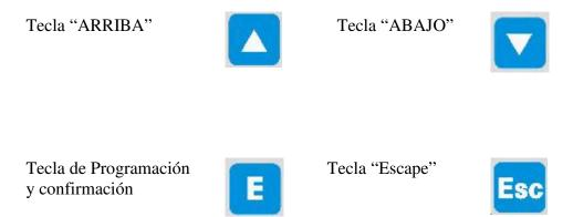
Para iniciar la programación mantener apretada la tecla "E" durante tres segundos. A partir de este paso, se detendrá la dosificación y aparecerá en el display las opciones de programación de SET-P y CALIB. Luego, con la tecla ABAJO, se podrá acceder a TEMP (para las bombas pH-CP), y la opción MODO, que se detallan a continuación:
