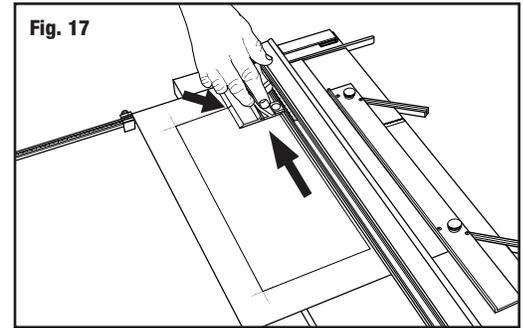
**NOTA:** A la hora de cortar es esencial presionar el sujetador de la cuchilla hacia debajo de forma estable.
