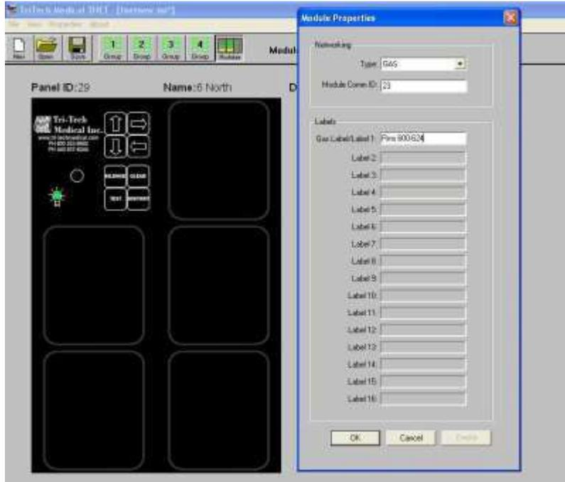
El módulo de gas se verá como se muestra en el ejemplo siguiente. El servicio de gas real, en este caso oxígeno, se comunica entre el panel de alarma y el software de T-Net, y se verá cuando se ejecuten los conjuntos de servidor y de cliente del software de T-Net. Repita los dos últimos pasos para los módulos de vacío medicinal y aire medicinal.
