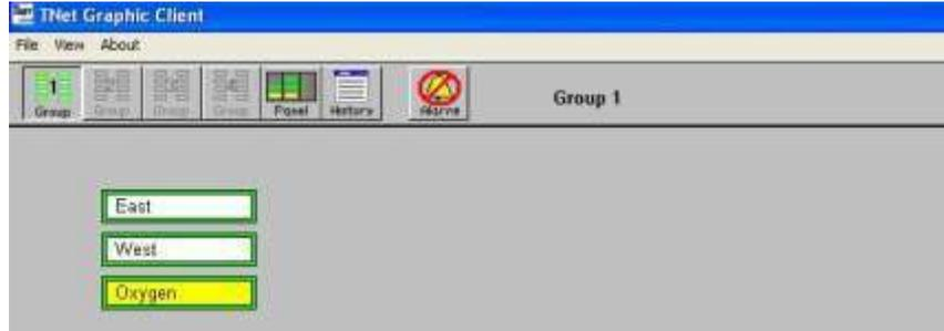
Cuando se hace doble clic en el ícono de Oxygen (Oxígeno), se abre la vista del panel de ese ícono y se muestra el estado real de ese equipo prácticamente en tiempo real.
