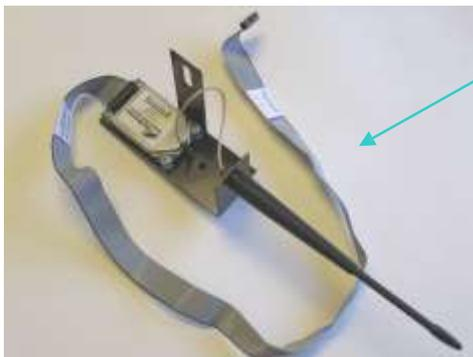
Hay tres tipos de tarjetas de circuitos de la interfaz (todos incluyen un soporte y un conector de cable): RS485, de Ethernet o inalámbrico. Aquí se muestra la placa de interfaz Ethernet arriba y la placa inalámbrica abajo.
