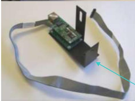
Las alarmas de la serie DU/DC de Tri-Tech Medical pueden adquirirse sin las tarjetas de circuitos de la interfaz T-Net. Las tarjetas de circuitos de la interfaz T-Net pueden instalarse en otro momento.
