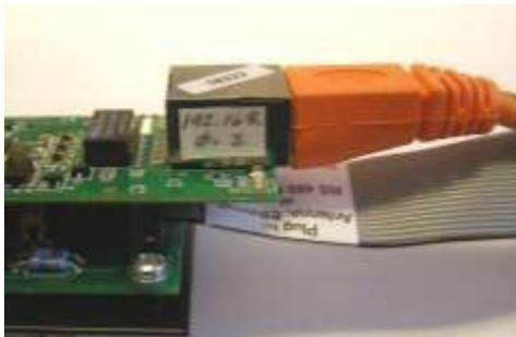
Aquí se muestra un cable de Ethernet típico conectado a la tarjeta de circuitos de la interfaz de T-Net.
