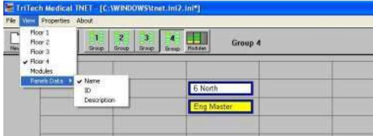
Aparecerá una representación gráfica del equipo definido (hasta ahora). Asegúrese de que la imagen coincida con el equipo que desee que represente (panel de alarma o colector) y que el número de ranuras verticales (si es un panel de alarma) coincida con la alarma que desea que represente. En este ejemplo hay tres ranuras verticales o columnas en la alarma. Si alguno de estos dos elementos no coincide, debe corregirse antes de continuar.
