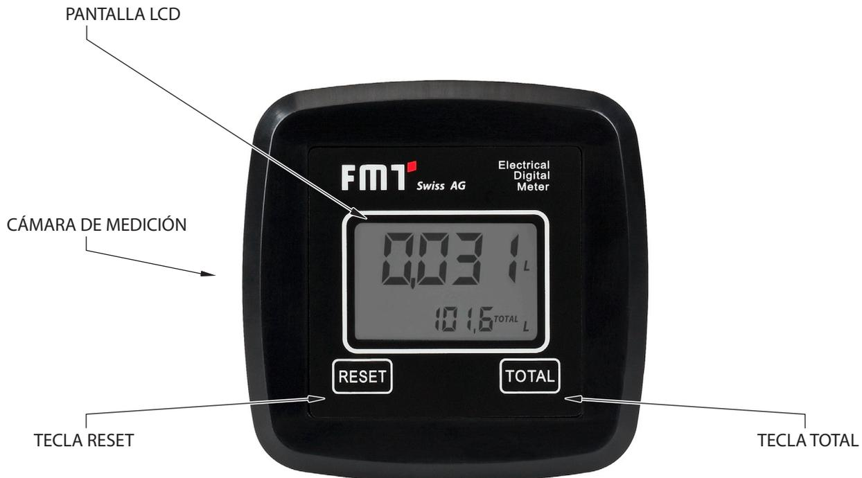
El sistema electrónico de medición y la pantalla de cristal líquido, "LCD" están instalados en la parte superior del contador de ruedas ovaladas, aislados de la cámara de medición y sellados por una tapa del área exterior.
