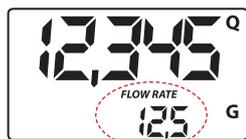
A diferencia del modo normal no se atraviesa en este caso la fase durante la puesta a cero, en la que primero se conectan y después se desconectan todos los segmentos de pantalla, sino que se indica directamente el registro de la cantidad parcial puesta a cero.
